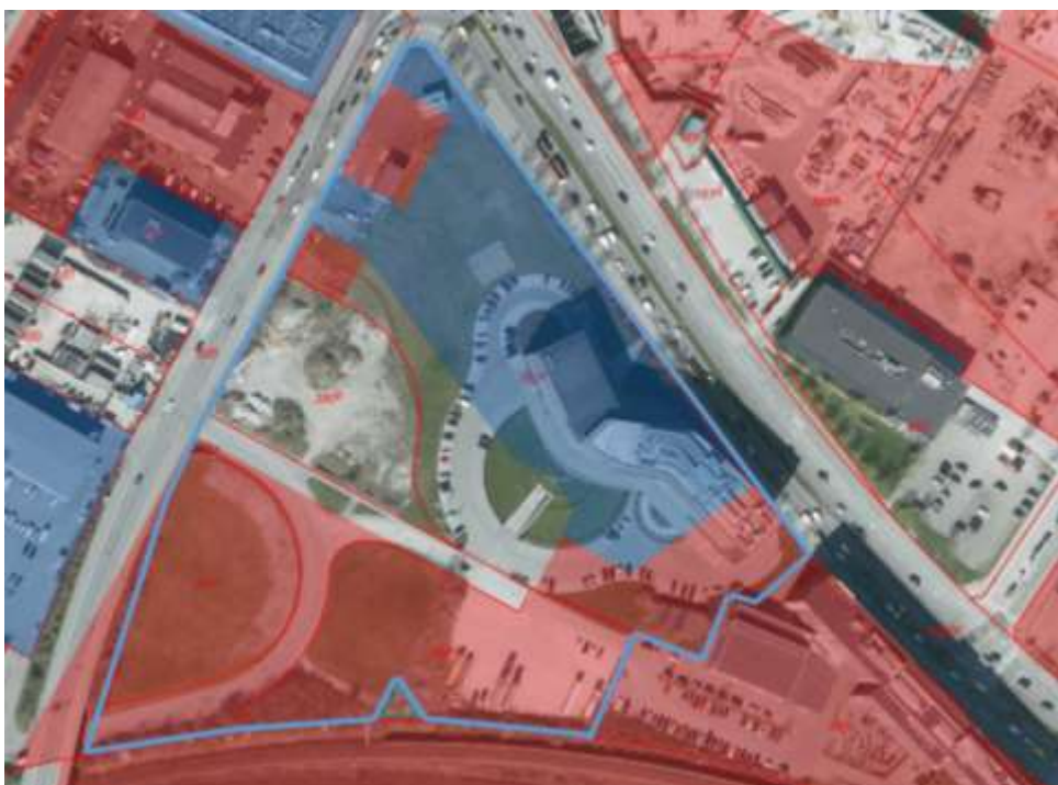
Figur 1 Oversigtskort over området, der viser placering af byggefeltet markeret med blå streg/skravering. Af kortet fremgår desuden matrikler og forureningskortlægning. Røde markeringer er områder med konstateret forurening (V2), Blå markeringer er områder med mulig forurening (V1).
