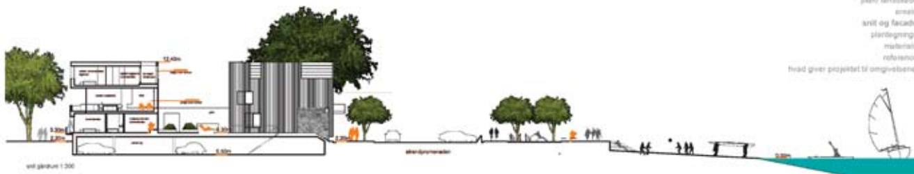
Snit i gårdrum set mod nord. Gårdrummene er hævet 1 - 1,2 m over terrænniveau og parkeringskælder indrettes under bebyggelsen. Rækkehuse og dobbeltvillaer er i 3 etager.
