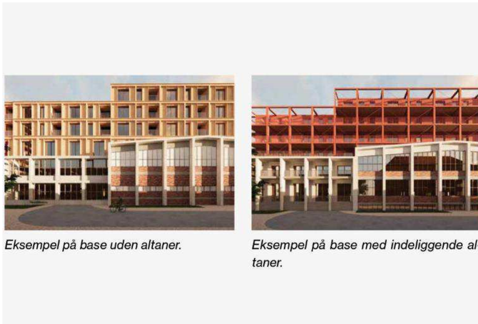
Figur 5-109 Skitser af hvordan facaderne på Værkstedet og Eftersynshallen kan udformes med ny bebyggelse bag facaderne og altaner. Eksemplet til højre kan ikke realiseres indenfor lokalplanens bestemmelser, da tegltavlerne ikke bevares i et omfang, som opfylder lokalplanens bestemmelser. Illustration Cobe.
