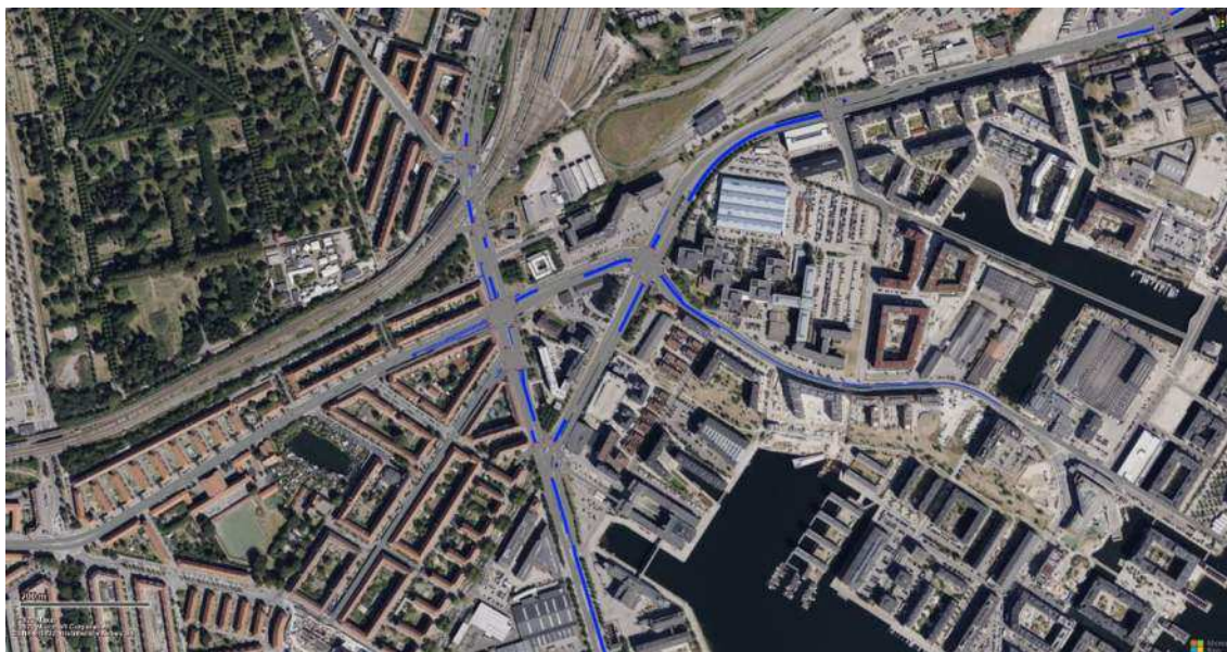
Figur 6-21 Kort med den sydvestlige del af trafikmodellen som viser de beregnede gennemsnitlige kølængder i Basis 2019 (kl. 15:00-17:00)
