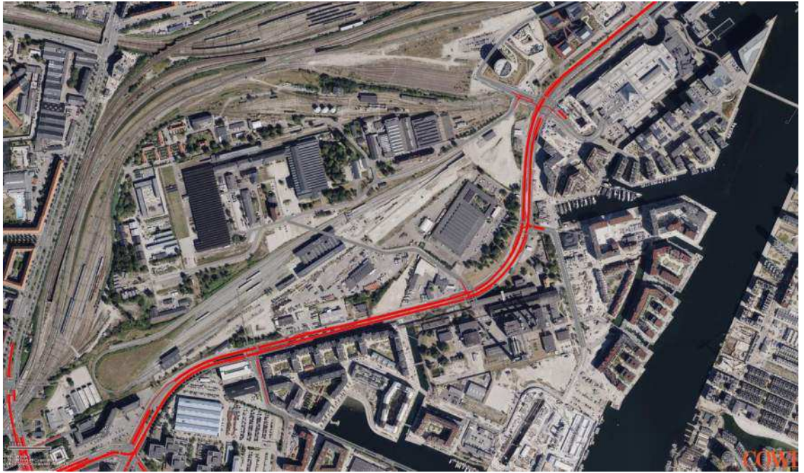
Figur 6-43 Kort med den nordlige del af trafikmodellen som viser de beregnede maksimale kølængder i Basis 2035 (kl. 7:00-9:00).
