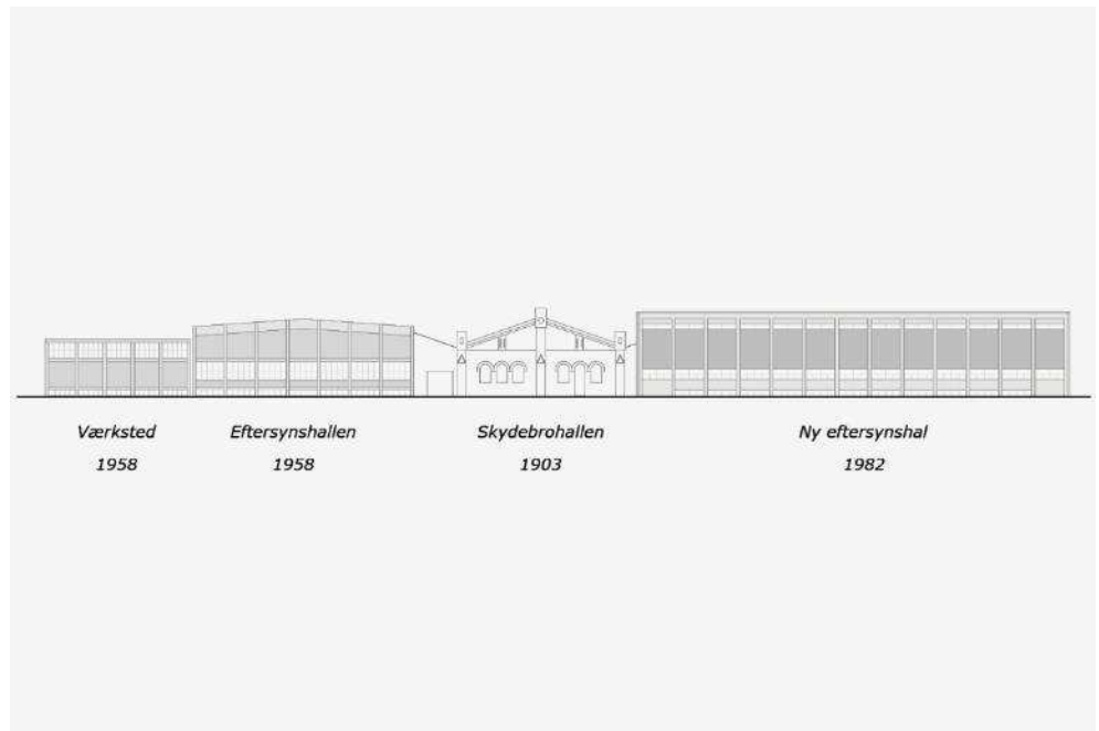
Figur 5-101 Illustration af facaderne på Godsbanens remise mod syd langs Otto Busses Vej. Facaderne er en tidslinje, hvor bygningernes arkitektoniske udtryk, materialer og byggeteknik udtrykker den tid de er opført i. Den sammenbyggede facade fortæller at bygningernes indbyrdes hænger sammen i remisen. Tegning Cobe.
