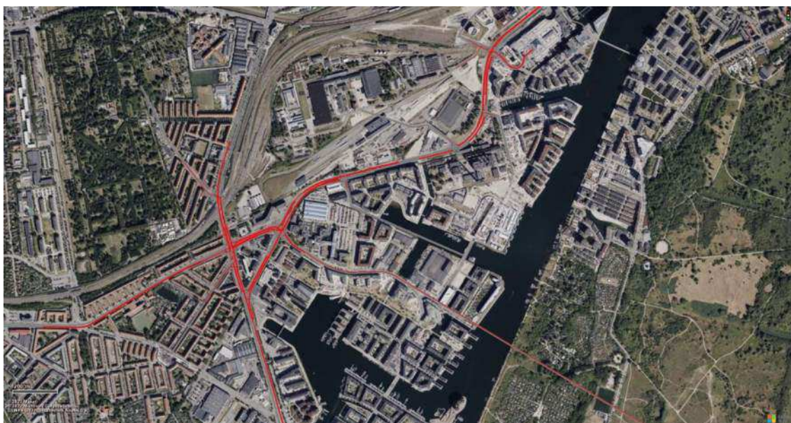
Figur 6-37 Kort med den nordlige del af trafikmodellen som viser de beregnede maksimale kølængder i Basis 2019 (kl. 7:00-9:00).
