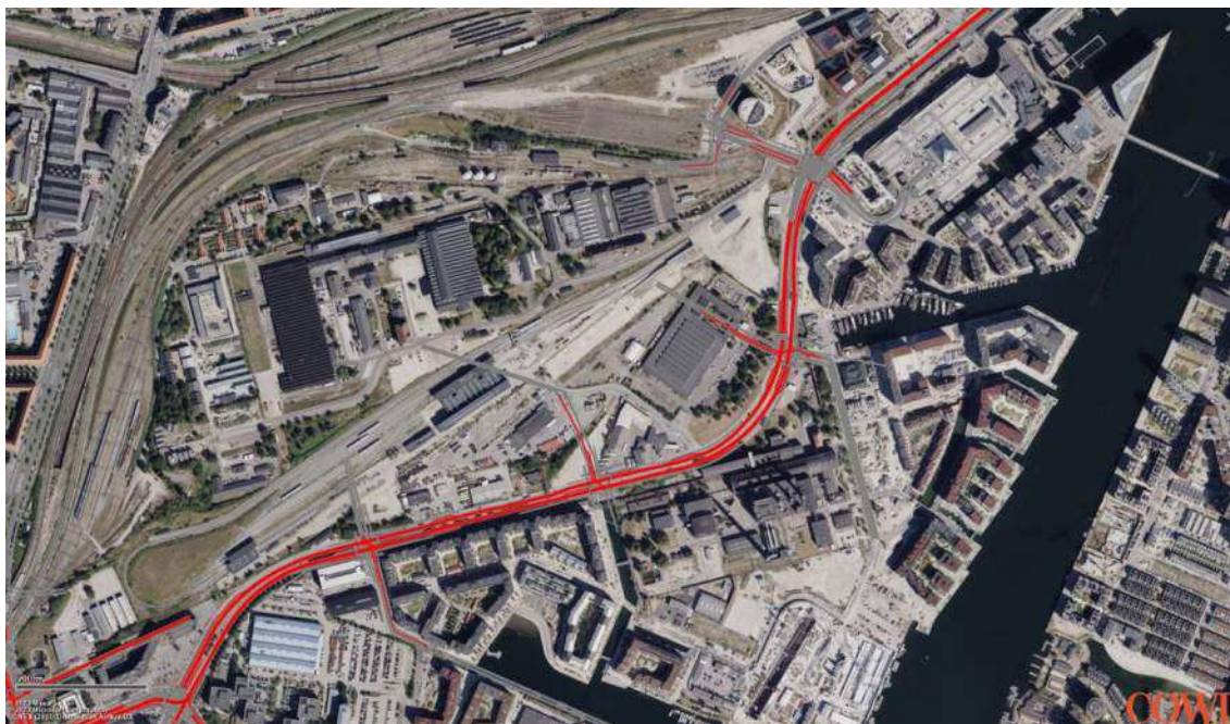
Figur 6-49 Kort med den nordlige del af trafikmodellen som viser de beregnede maksimale kølængder i Scenario 2035 (kl. 07:00-09:00).
