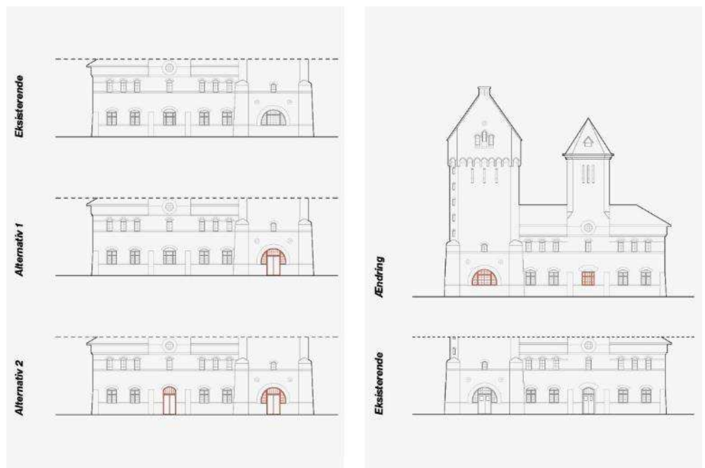
Figur 5-96 Skitserede ændringer af vinduer og døre i Vandtårnet, se tekst om særlige bestemmelser. Tegning Cobe.
