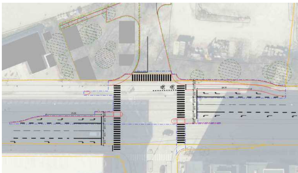
Figur 3-6 Foreslået krydsudformning for det signalregulerede kryds ved Vestre Teglgade/Vasbygade. Det sidst tilføjede ben mod nord vil kun håndtere trafik til/fra CMC. Krydsudformningen anvendes i Scenario 2035.
