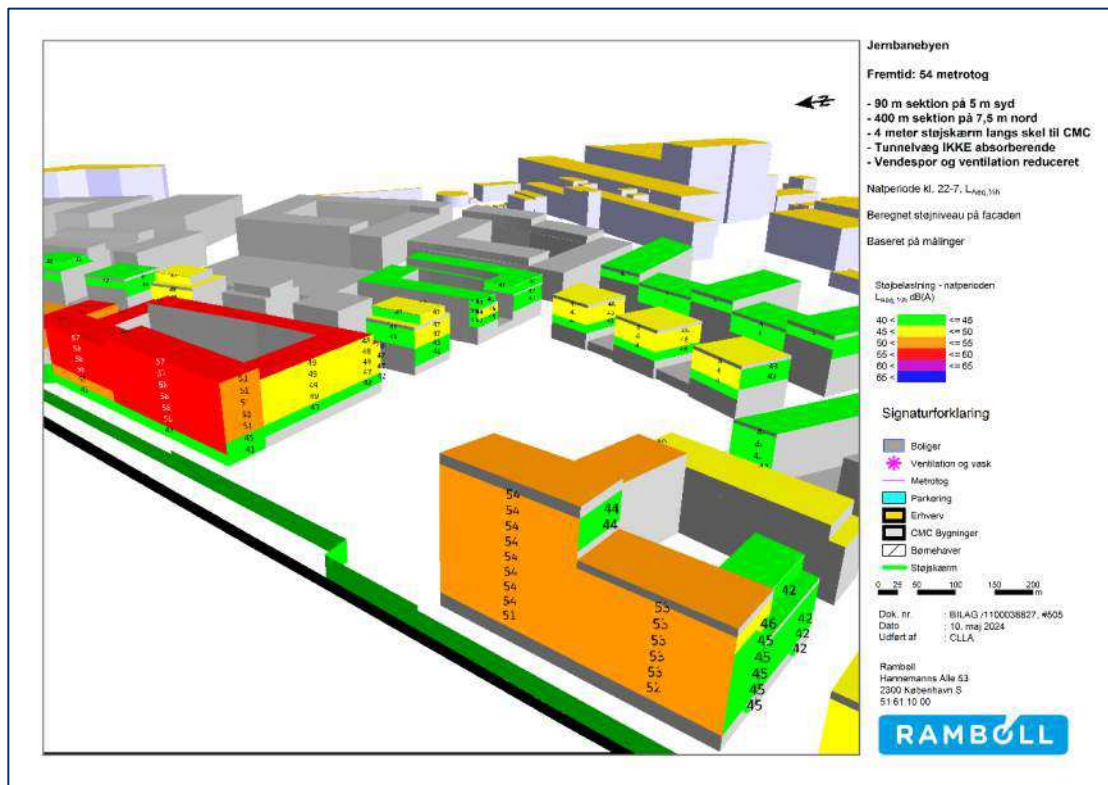
Figur 19-19. Scenarie: Reduceret støj uden overdækning. 3D opstalt af beregnet støjniveau på facaden i natperioden. Grå facader er udsat for støj med niveauer under 40 dB.
