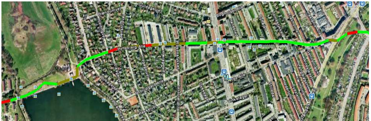
Figur 5 Jævnhedsmåling i den nordlige vejside. Lys grøn: BPI < 12 , Olivengrøn: 12 < BPI < 15 og rød: BPI > 15
