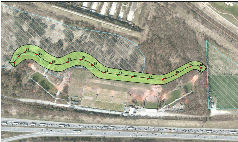
Figur 1: Skitse af støjvoldens placering og udformning
