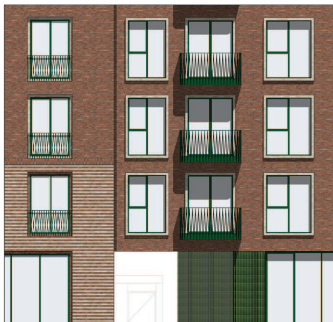
Facadeudsnit, der viser variationen i brug af gule og røde mursten samt beklædningen med grønne, glasserede sten i stueetagen.
