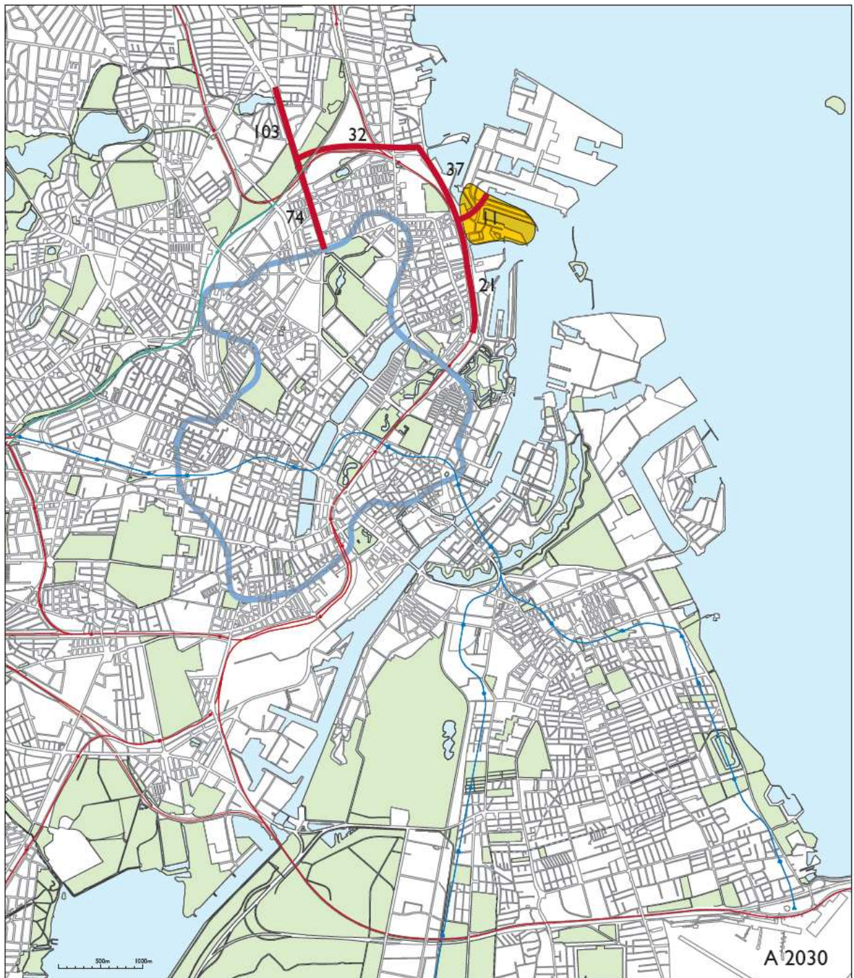
Trafiktal (antal køretøjer pr. døgn, ÅDT x 1000) for scenario A, beregnet for år 2030. Beregningen er udført af Tetraplan.
