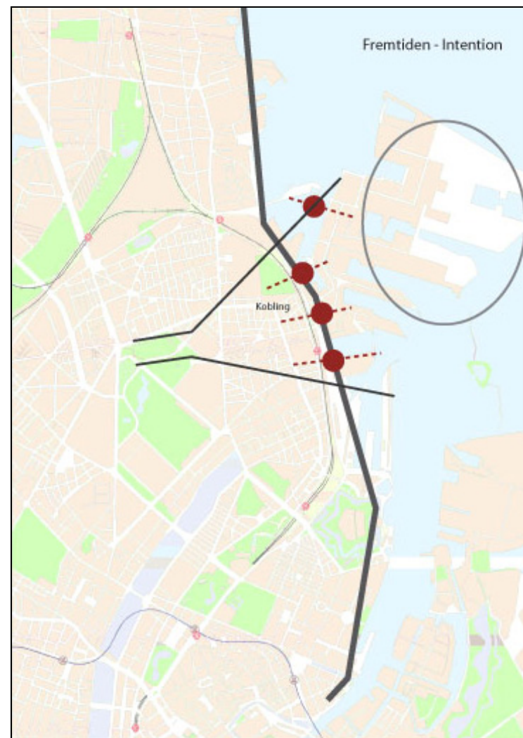
Figur 5.2. Barriereeffekten nedbrydes ved at skabe flere krydsningspunkter af banearealet.
