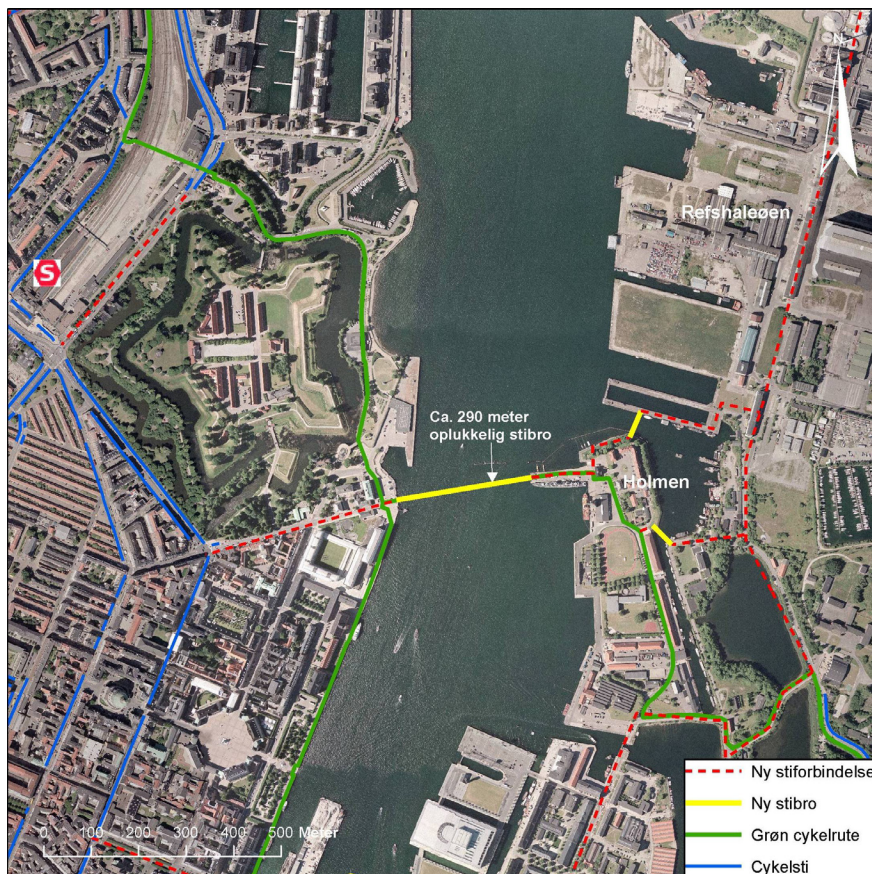
Figur 7.5. Broforbindelse fra Nyholm til Nordre Toldbod.
