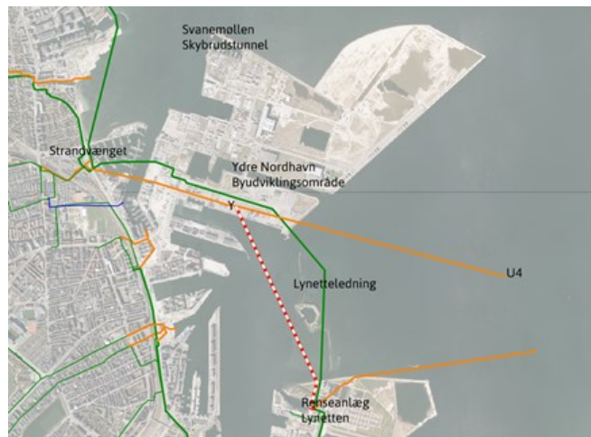
Figur 1. Principielt tracé for projektet er vist med rød-hvid stiplede streg. Overløbs- og udløbsledninger er vist med orange. Øvrige hovedledninger er vist med grøn.
