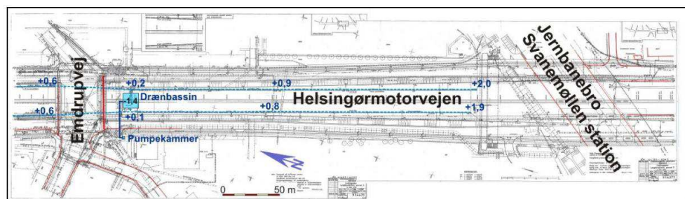
Figur 4-3 Placering af dræn og bassiner og koter til bund af ledninger og af bassiner. Kopi af figur fra Rambøll 2010. Bemærk orientering af nordpil.
