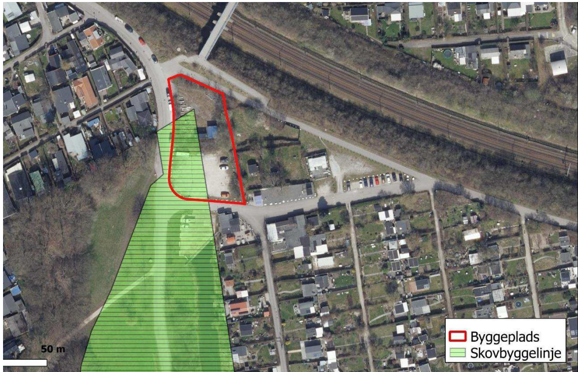
Figur 15.4: Den sydvestlige del af byggepladsen ved Musikbyen ligger indenfor den eksisterende skovbyggelinje for fredskovsområdet i Valbyparken
