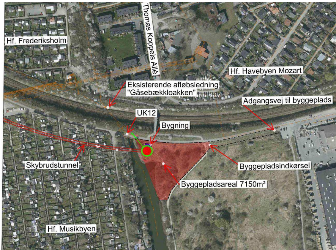
Figur 2.5 Byggepladsareal ved Enghave Kanal og Sydhavnstippen.
