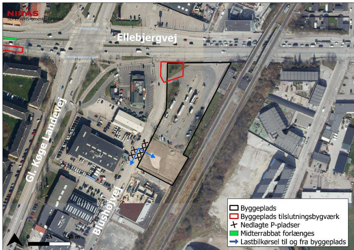
Figur 8.7 Byggeplads for skakt ved Blushøjvej med adgang for tung trafik, samt p-pladser, der nedlægges.
