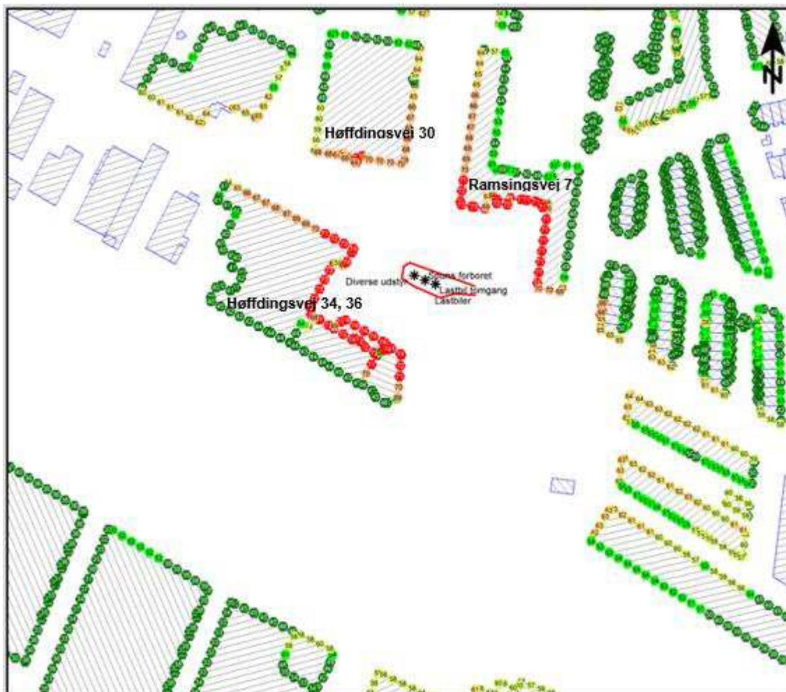
Figur 9.2: Støj fra anlægsarbejder i byggefase 8a for byggepladsen ved FLSmidth, hvor der etableres vægge til tilslutningsbygværk som københavnervejge/forboret spuns. Støj kortet medtager ikke tillæg for hørbare impulser på 5 dB.
