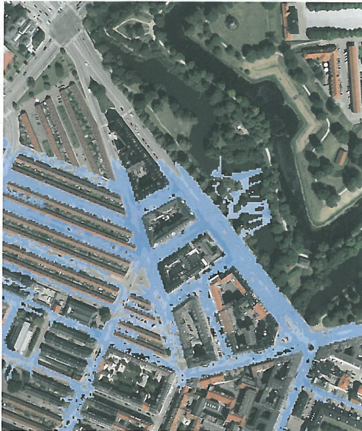
Figur 14 Simuleret oversvømmet areal ved en 100-års regnhændelse
