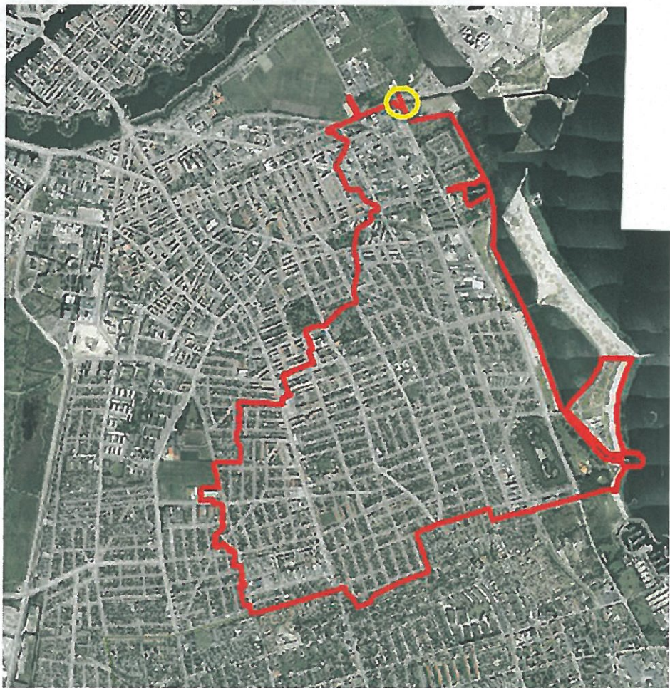
Figur 22 Opland til overløbet fra Amager Brygge med placering af udledning
