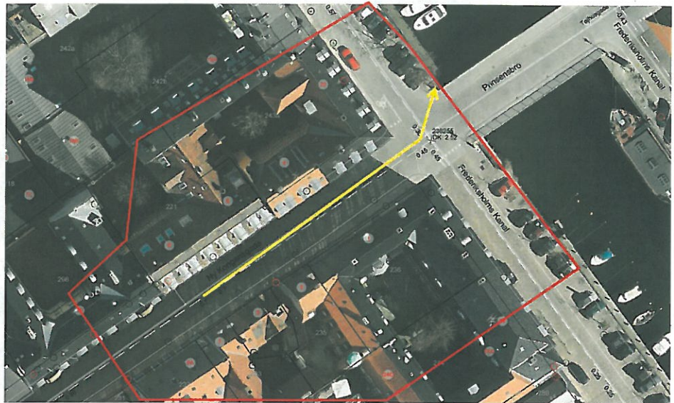
Figur 8 Opland til Frederiksholms Kanal med udledningspunkt
