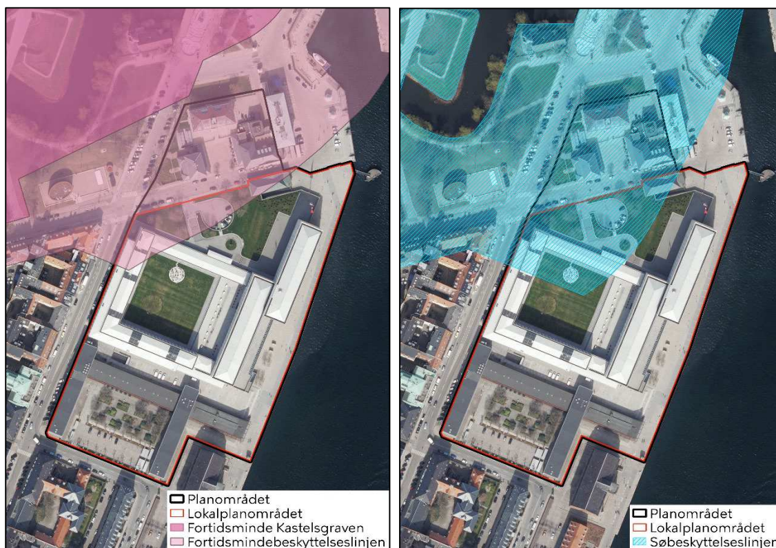
Figur 4.4.2.1 Beskyttelseslinjer i planområdet: Fortidsminder og fortidsmindebeskyttelseslinjen (tv.) og søbeskyttelseslinjen (th.) (Kilde: KK).
