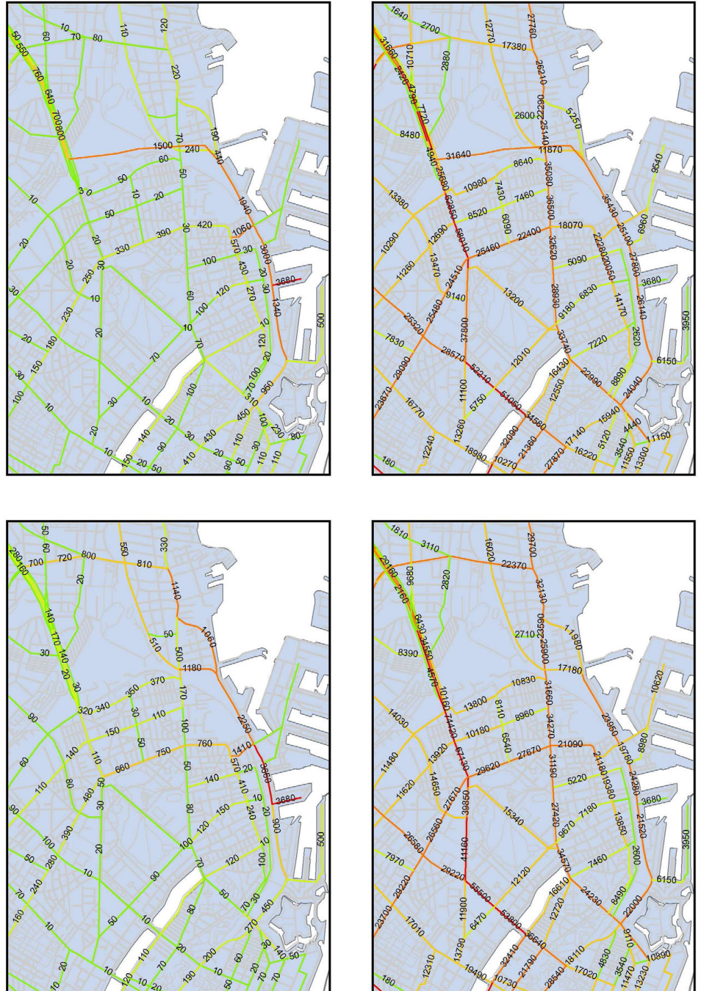
Figur 6-1 Prognoser for trafikaler efter udbygning af lokalplanområdet
