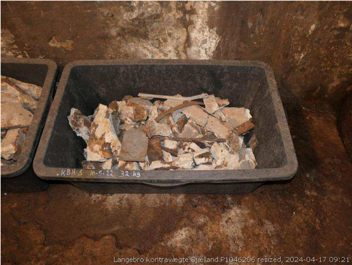
Afskallet beton fra kontravægten opsamlet i spande
