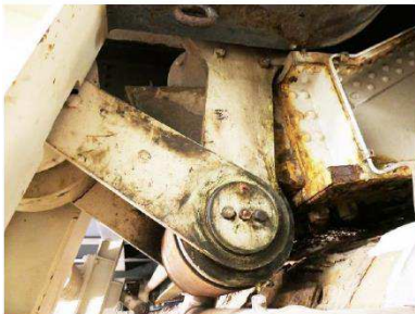
Figur 9: Baskuleringsarm, -rulle og -horn i lukket tilstand.
