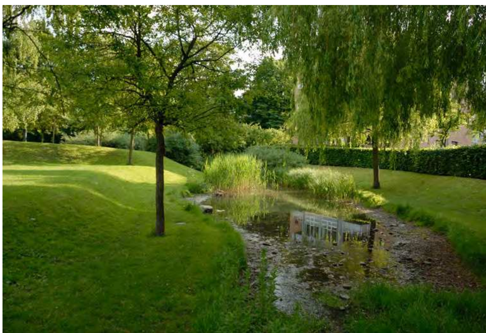
Figur 7-5 Eksempel på et lille bassin til lokal opsamling af regnvand i et boligområde på Frederiksberg nær Sankt Jørgens Sø.
