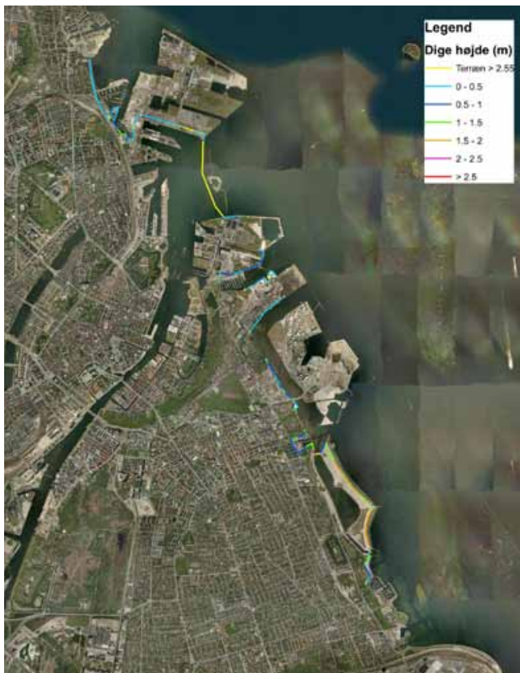
Figur 5: Områder, hvor der er behov for lokal sikring for at beskytte mod højvande.
