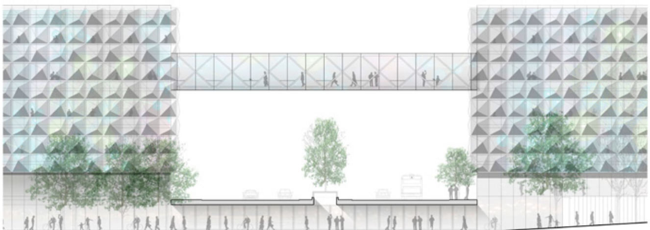
Broen over Jagtvej udformes i gitterkonstruktion og med glasfacader.
