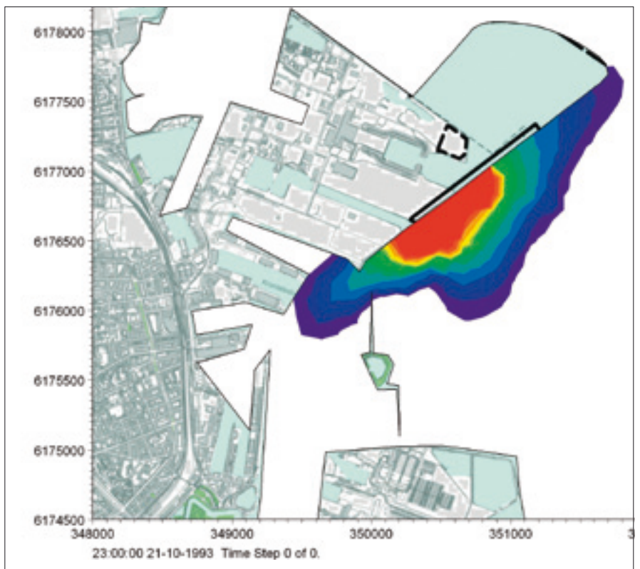
Figur 38 Aflejring af sedimentspild (i cm) som følge af ud- dybning af området langs krydstogtterminalen.
