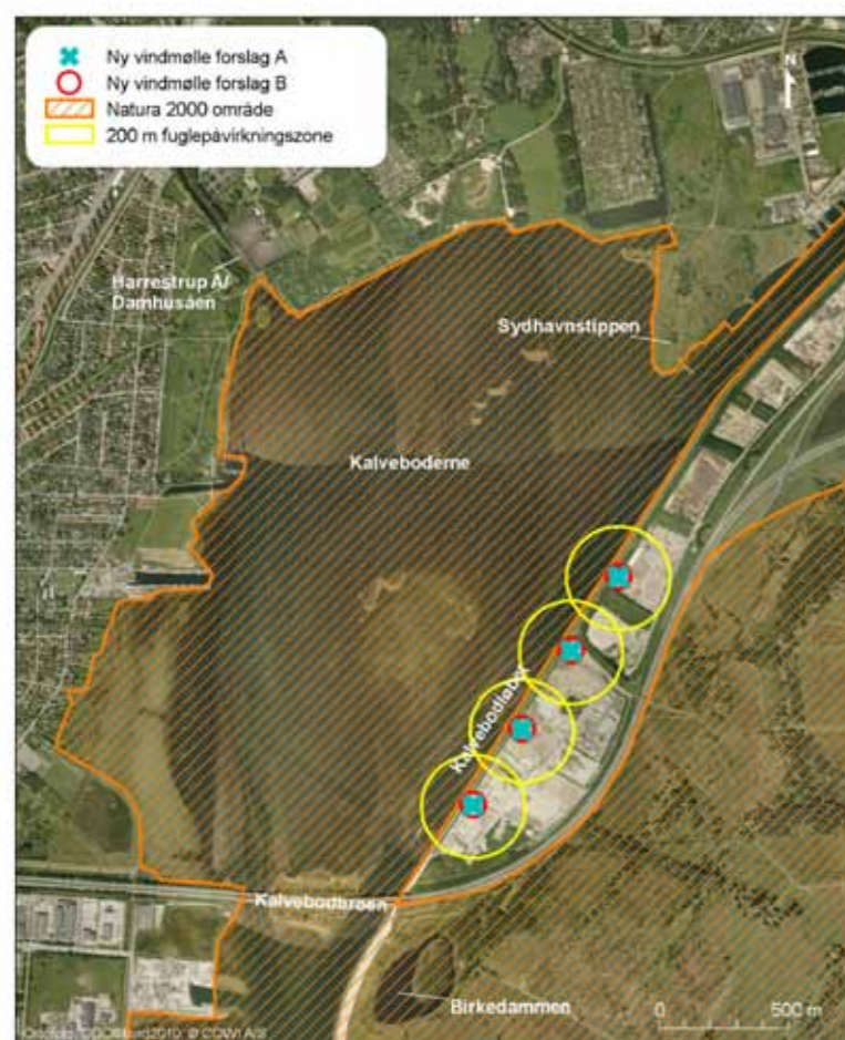
Figur 11.1 Mølleplaceringerne med en 200 m zone udenom, der angiver det område, hvor der ifølge andre danske undersøgelser kan ventes en påvirkning af troldand, her kaldet fuglepåvirkningszonen.
