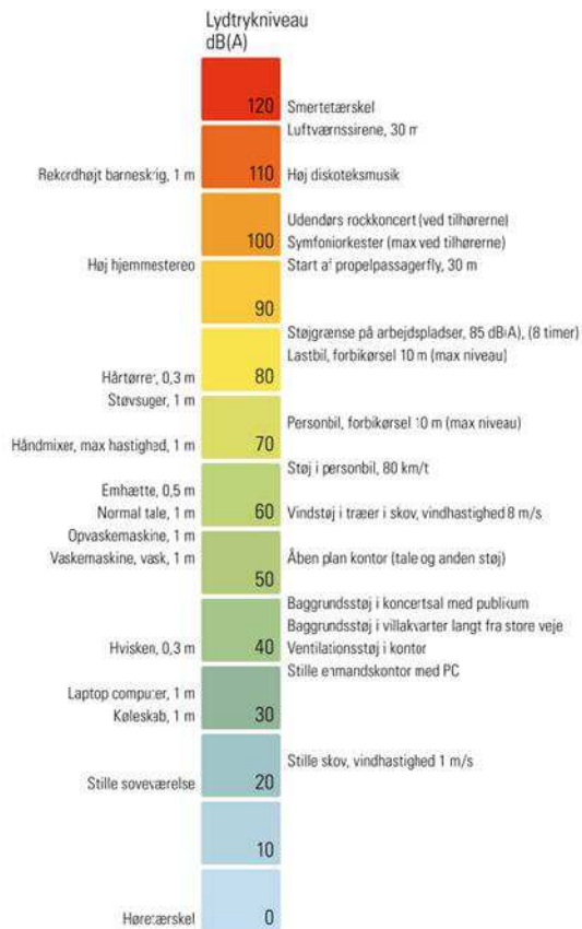
Figur 9-1 For at give en ide om, hvad forskellige støjniveauer svarer til, figureres her et "støjbarometer", som angiver støjniveauet fra forskellige kilder i forskellig afstand (kilde: Force Technology).
