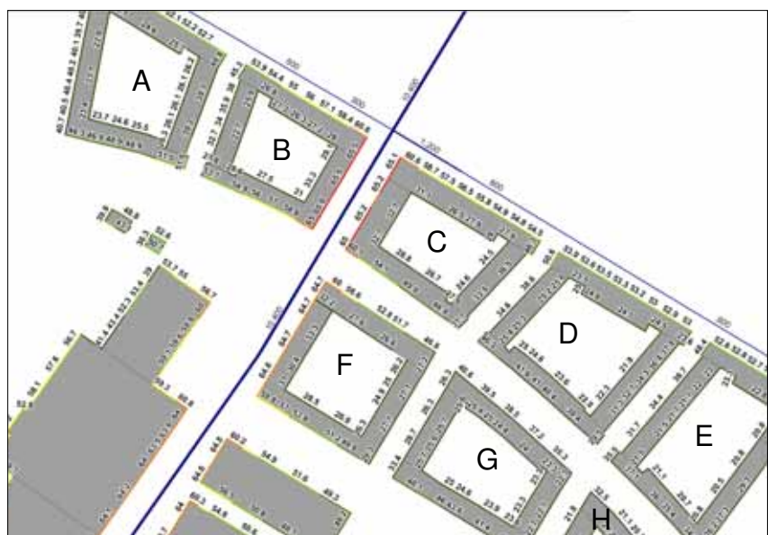
De mest belastede boliger i 1. sals højde får en støjbelastning på 65 dB(A)
