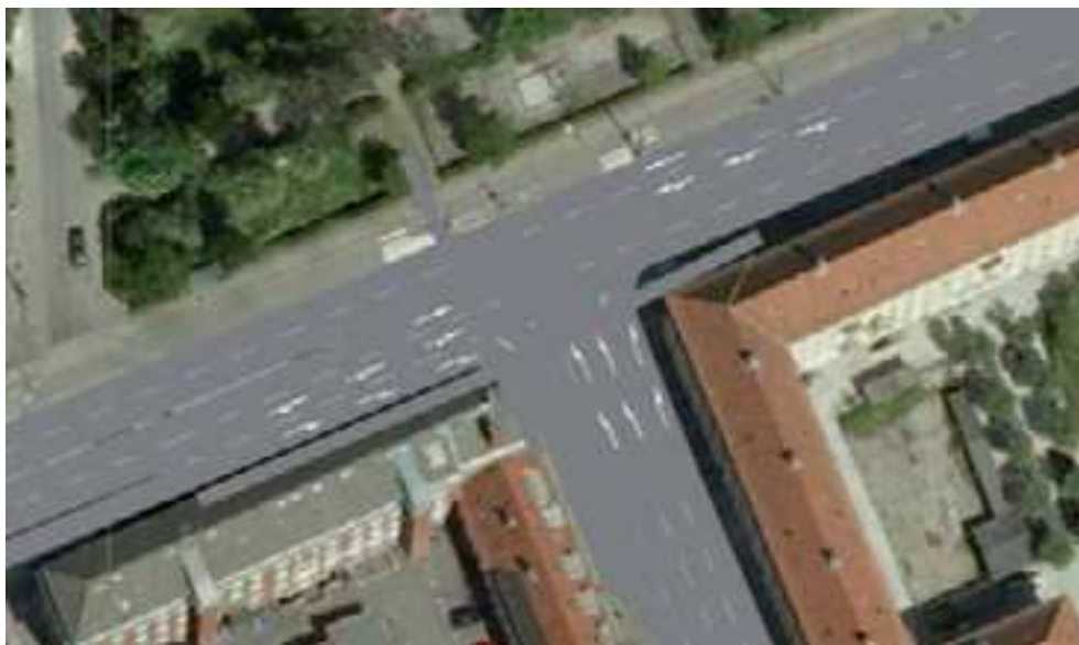
Figur 3.10 Krydset Jernbane Allé - Jyllingevej med ekstra busprioritering
