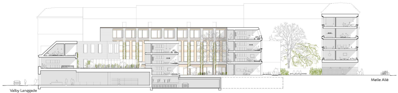
Principalsnit AA, der viser et eksempel på et nybyggeri i sammenhæng med omgivende eksisterende bygninger i overensstemmelse med lokalplanen. Illustration: Entasis.
