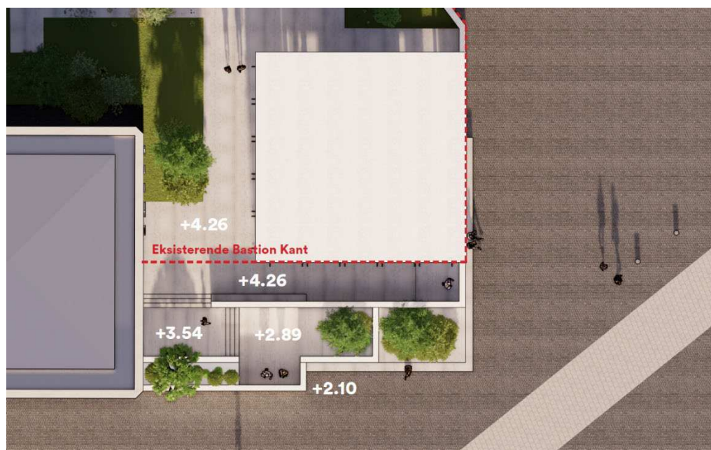
Figur 7.2.1.4 Placering af bygning med angivelse af højdekoter omkring bygningen (Kilde: Dorte Mandrup A/S).
