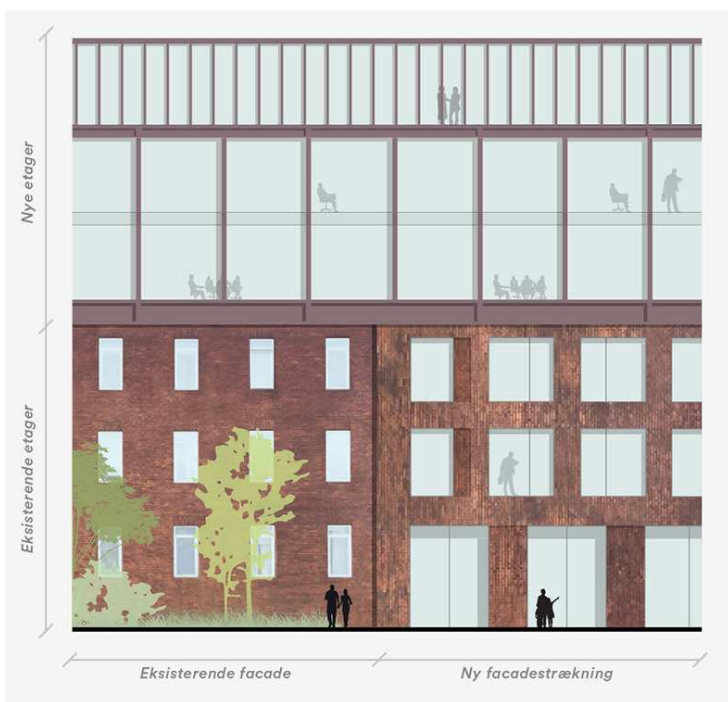
Illustration, der viser et eksempel på et udsnit af facaden i mødet mellem ny tilbygning og eksisterende bevaringsværdig bygning B mod nord. Illustration: Henning Larsen Architects og Kirkbi.
