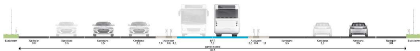
Figur 15 Tværsnit af Helsingørmotorvejen med indpassning af midterlagt BRT-tracé.
