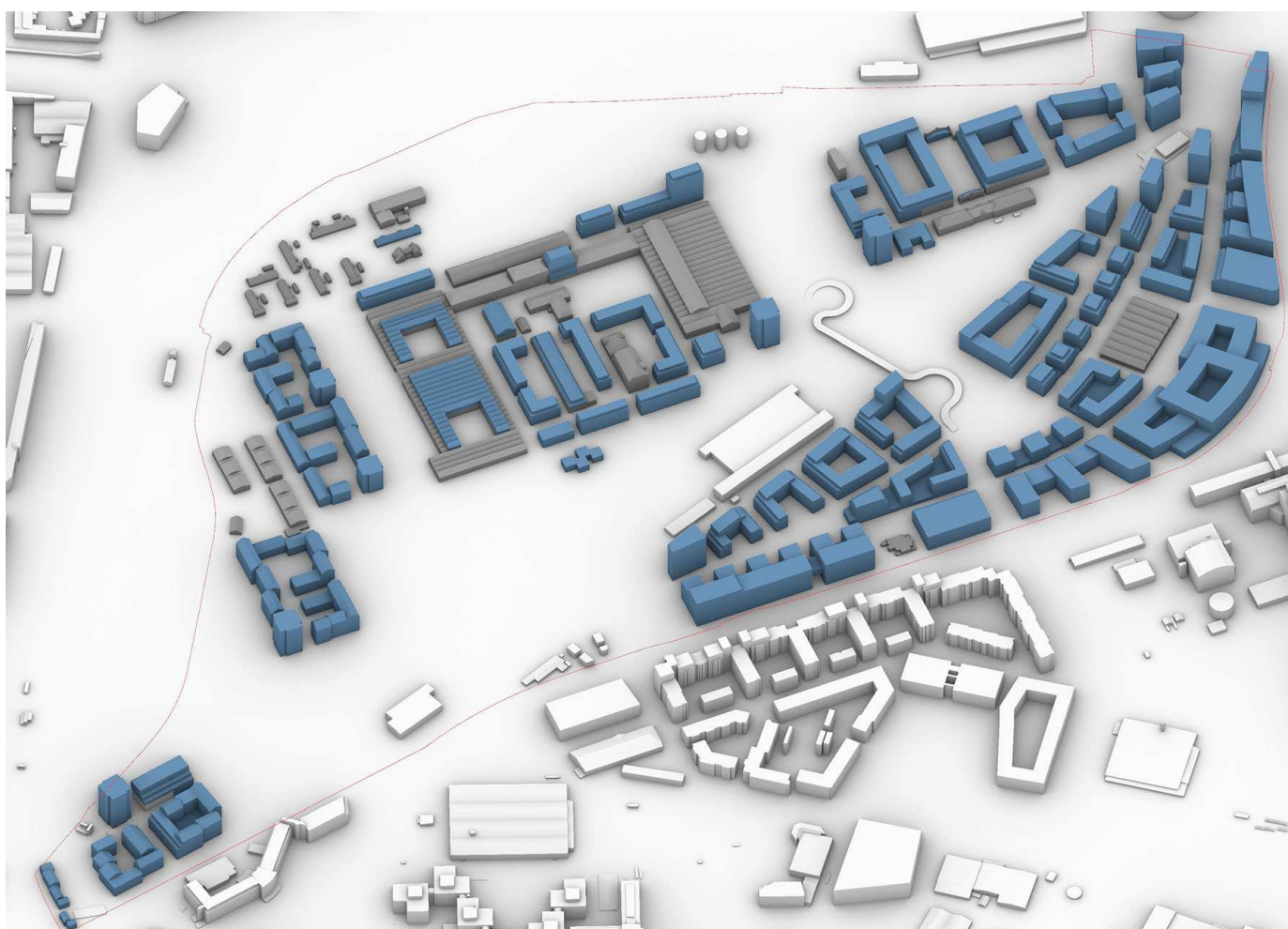
Volumenmodel, set fra sydvest, der viser et eksempel på en mulig bebyggelsesplan for Jernbanebyen i overensstemmelse med lokalplanens bestemmelser. Blå bygninger er nye bygninger og grå bygninger er eksisterende bygninger. I volumenmodellen vises det maksimalt muliggjorte bruttoetageareal. Da der er fleksibilitet i planen, kan etagemeterne i et realiseret byggeri være fordelt anderledes med højere bygninger nogle steder og lavere andre steder. Illustration: Team Cobe.
