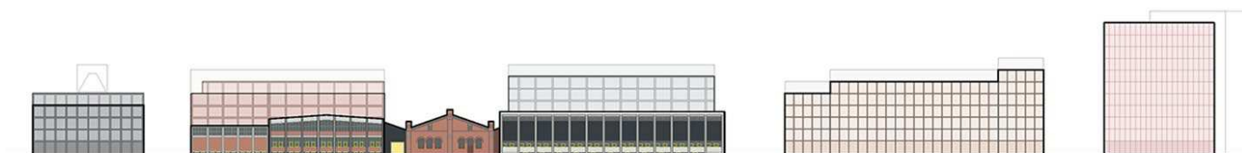
Ny bebyggelse og bygninger bag bevaringsværdige facader i delområde VI skal have en grid-struktur med vandrette og lodrette rammer og med udfyldte facadefelter. Illustration: Team Cobe.
