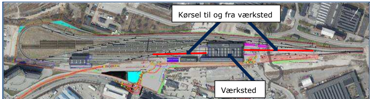
Figur 8-9. Kørsel til og fra værksted for metrotog, hvor der skal udføres reparationer og vedligeholdelse.
