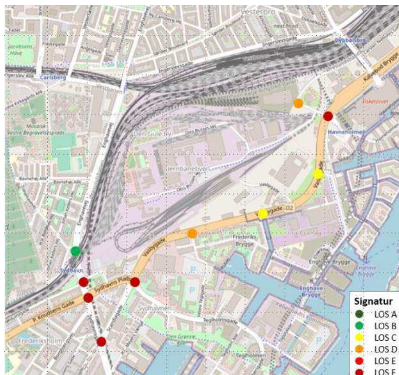
Figur 6-58 Beregnet serviceniveau (LOS) i Scenario 2035 i eftermiddagsmyldretiden . Definitionen af serviceniveauer er angivet i tabel 5-1.
