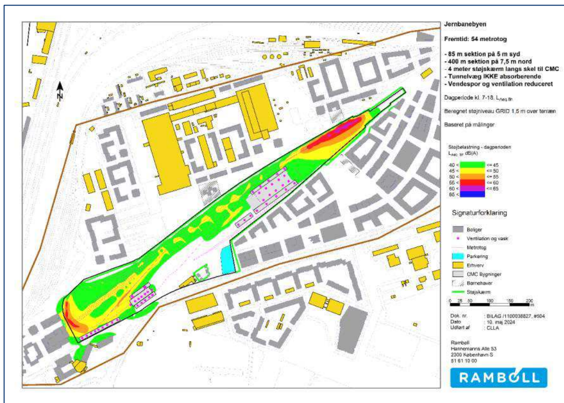
Figur 19-13. Scenarie: Reduceret støj uden overdækning. Beregnet støjniveau 1,5 meter over terræn i dagsperioden.
