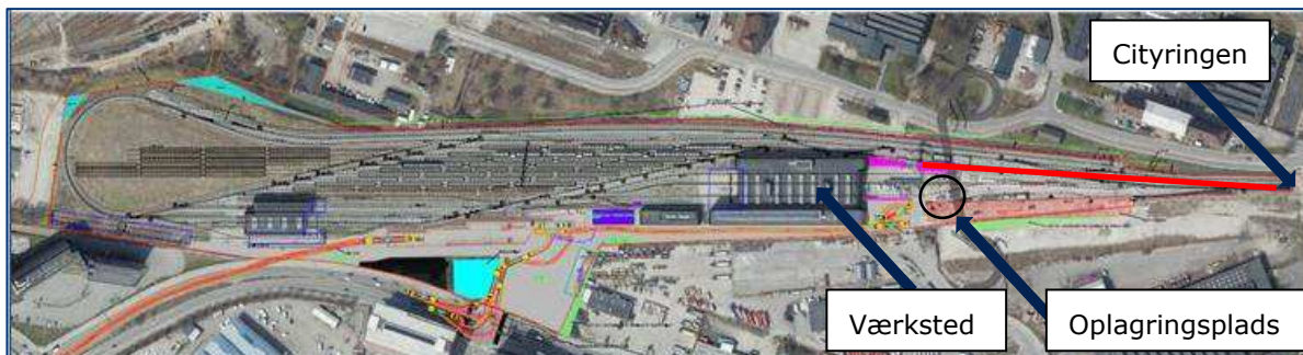
Figur 8-6. Trolje kører fra oplagingsplads med 20 km/t ind på Cityringen og tilbage igen efter udført vedligehold.
