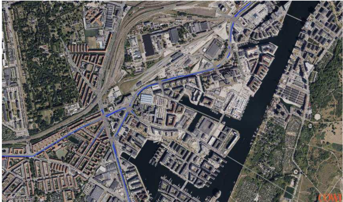
Figur 5-6 Kortet viser den beregnede gennemsnitlige kølængde i Basis 2035 i hele netværket (kl. 7:00-9:00). Det bemærkes, at der i beregning af køen fra vest frem mod Sydhavns Plads ikke er medtaget kryds længere mod vest end Enghavevej, hvorved køen alene beregnes fra Enghavevej og ikke med den opdeling af køen, som ellers vil forekomme i virkeligheden. Tilsvarende princip gælder for de øvrige veje frem mod beregningsvejnettet.
