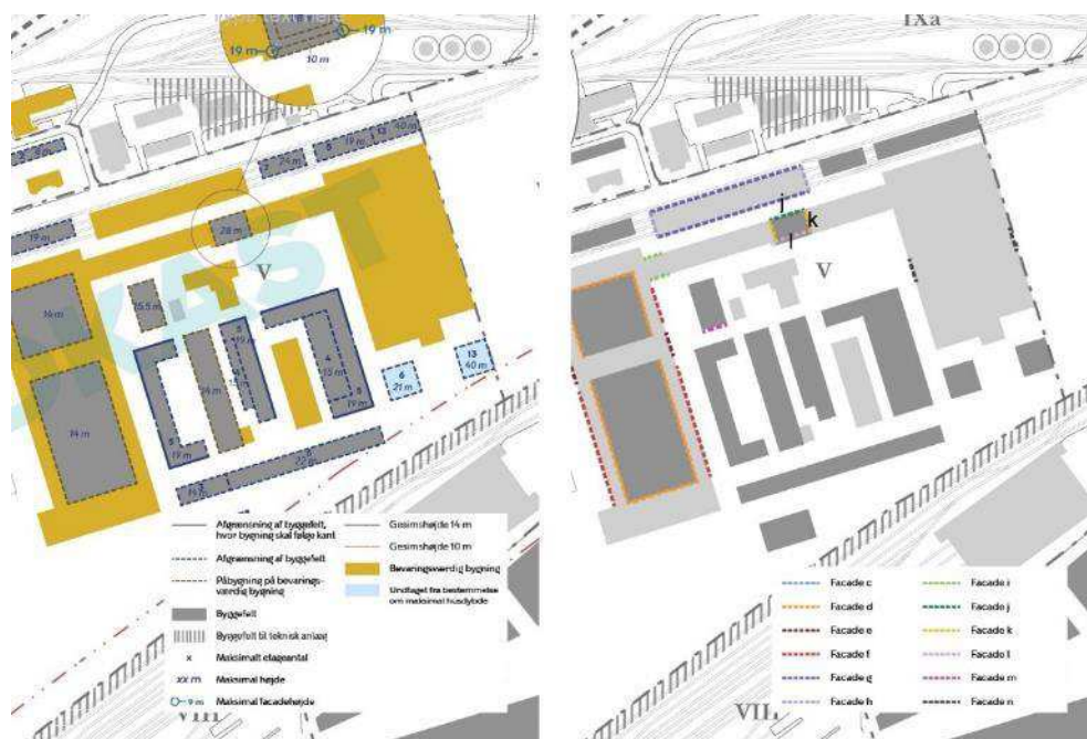
Figur 5-57 Tv. udsnit af tegning 5b3 · Bebyggelsens omfang og placering · IV, V, VII som viser hvilke muligheder der er for påbygning på Trykluftværkstedet. Th. udsnit af tegning 6d2 · Bevaring - ydre fremtræden · IV, V, VII.
