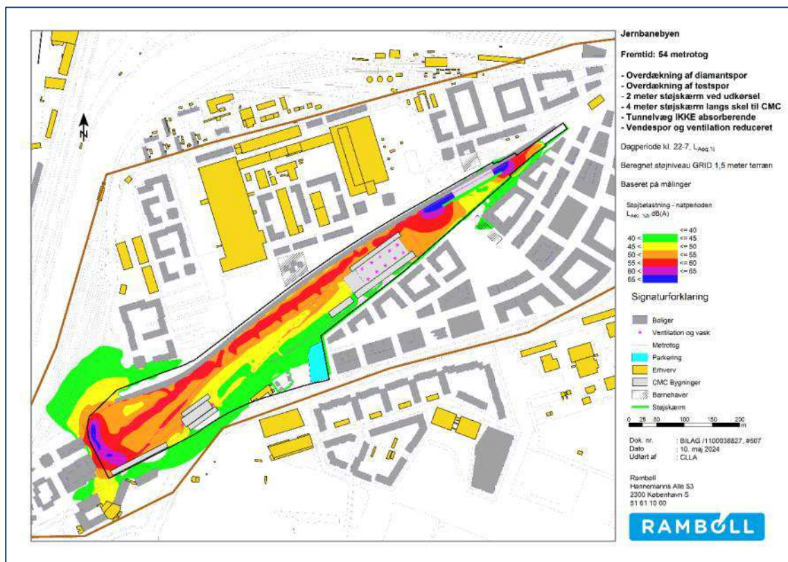
Figur 19-11. Scenarie: Reduceret støj med overdækning. Beregnet støjniveau 1,5 meter over terræn i natperioden.
