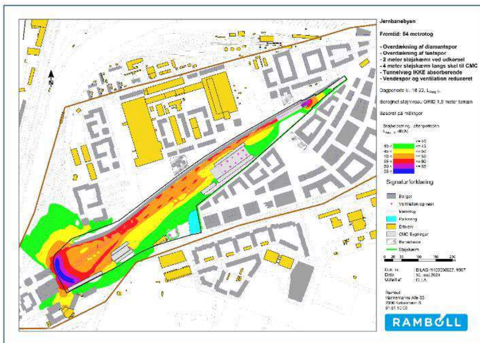
Figur 6-11 CMC. Støjdæpende tiltag i form af overdækning når planlovens § 15, stk. 2, nr. 29, jf. § 15a, stk. 1 finder anvendelse. Støjudbredelseskort aftenperioden (Rambøll).
