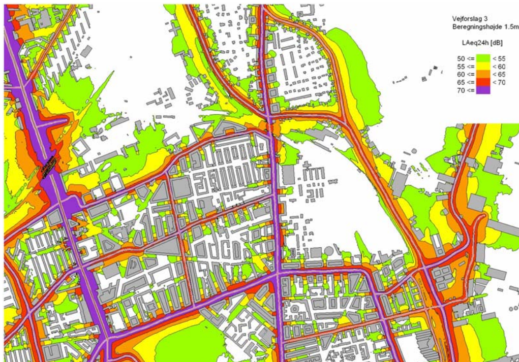
Figur 3.6 Støjuddbredelse ved vejforslag 3. På kortet er vejforslagets vestlige rampeanlæg markeret, mens det østlige rampeanlæg ikke er medregnet. Der må dog forventes en tilsvarende støjpåvirkning omkring dette rampeanlæg.
