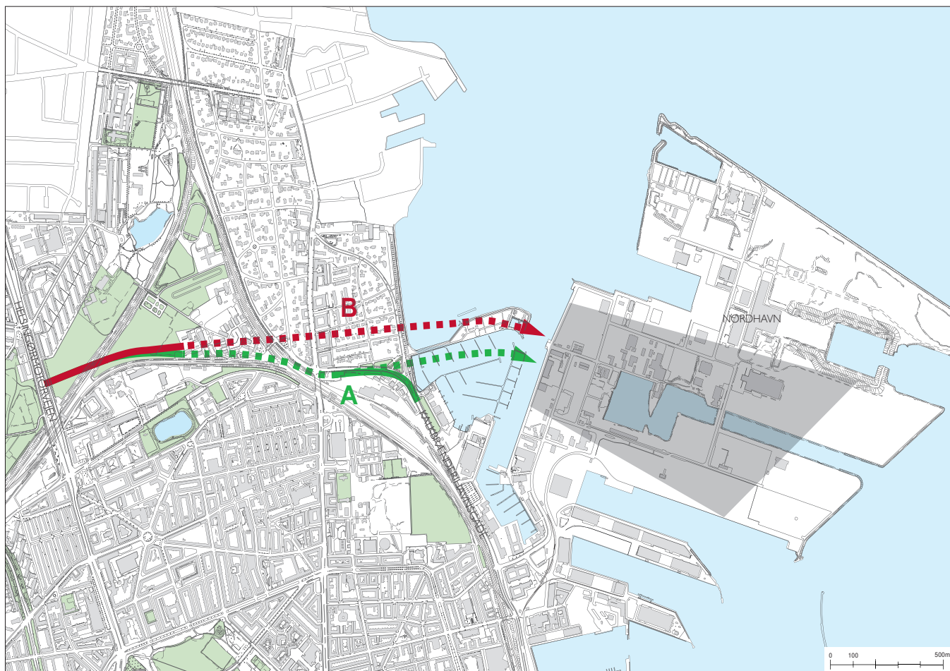
Vejforslag A og B. Fuld optrukken linje viser vej i terræn, stiplede linje er vej i tunnel. Det grå felt i Nordhavn angiver det område hvor indenfor vejen kan tilsluttes.
