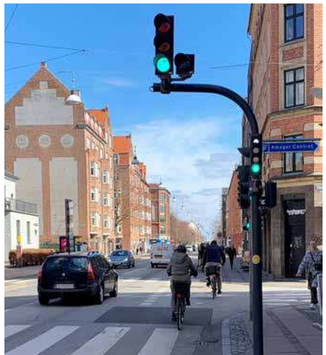
Slukket eftergrønt højresvingsspil for bilister til at prioritere cyklister på Holmbladsgade
