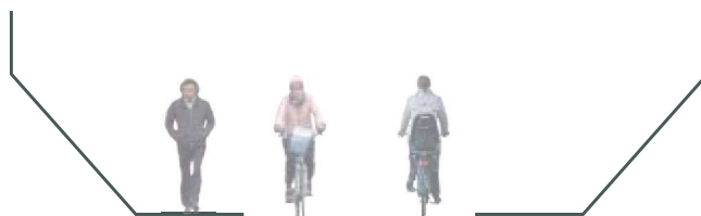
Figur 9: Tunnel med sider der hælder udad
