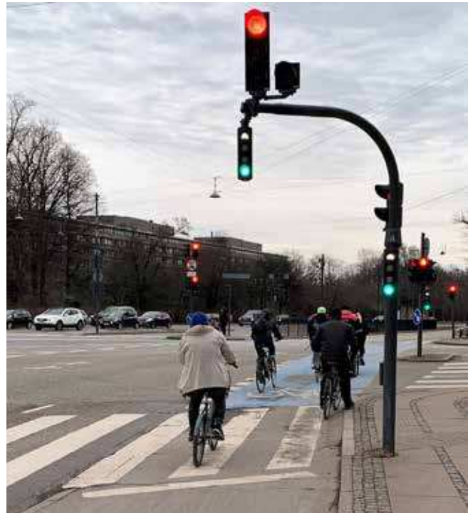
Slukket eftergrønt højresvingsspil for bilister samt færgørønt for cyklister til at prioritere cyklister, Tagensvej/Nørre Allé
