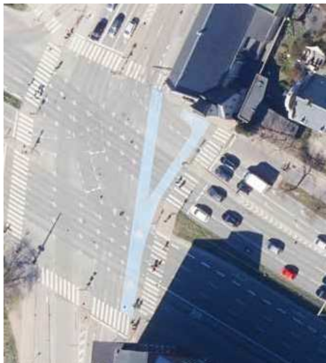
Venteområde til venstresvingende cyklister med blåt cykelfelt, Gyldenløvesgade/Nørre Søgade, foto Bydata
