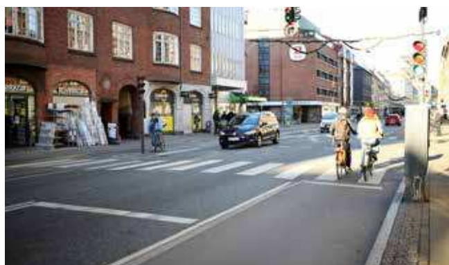
Fremført cykelsti og højresvingsforbud for bilister, Amagerbrogade/Brysselsgade
