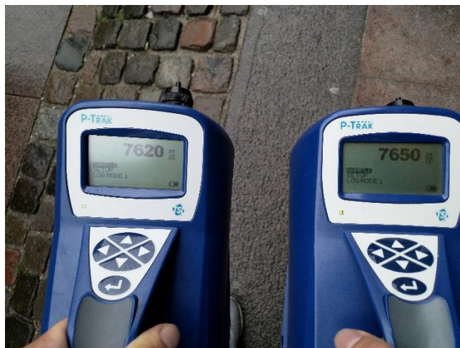
Billede 2 Viser henholdsvis Miljøpunkt Nørrebros og Miljøpunkt Indre bys måleapparat der måler parallelt. Målerne målte ens med en ubetydeligt lille forskel. (Eget billede, 2018)
