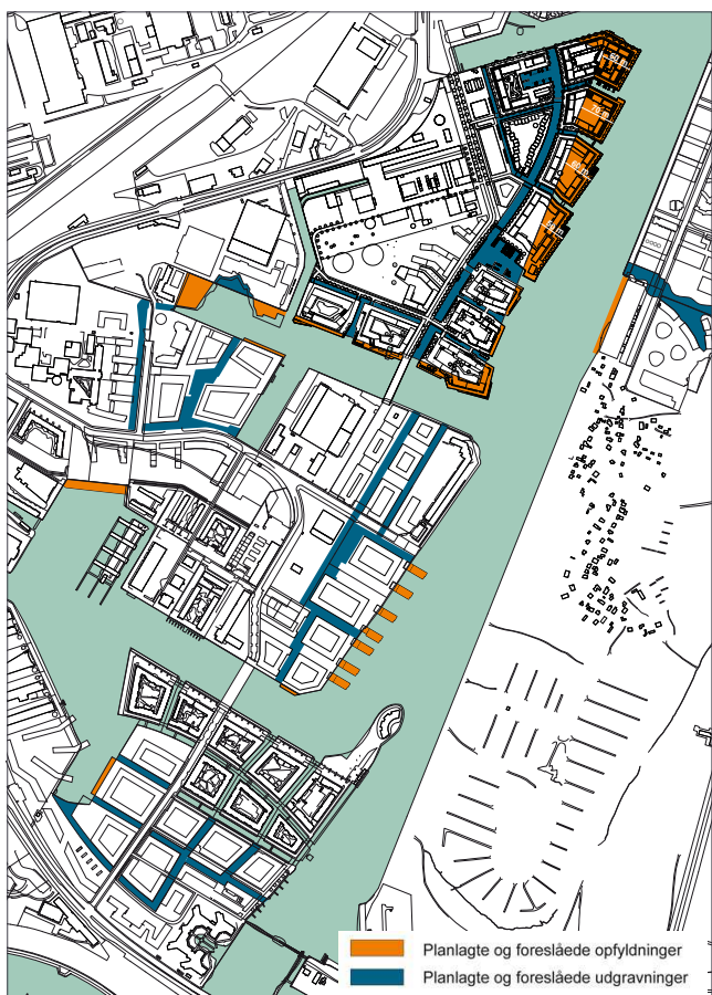
Opfyldt og udgravning i Sydhavnen. På Enghave Brygge afgraves ca. 30.000 m 2 og opfyldes ca. 35.000 m 2 . Bebyggelsesplanen er ikke opdateret.
