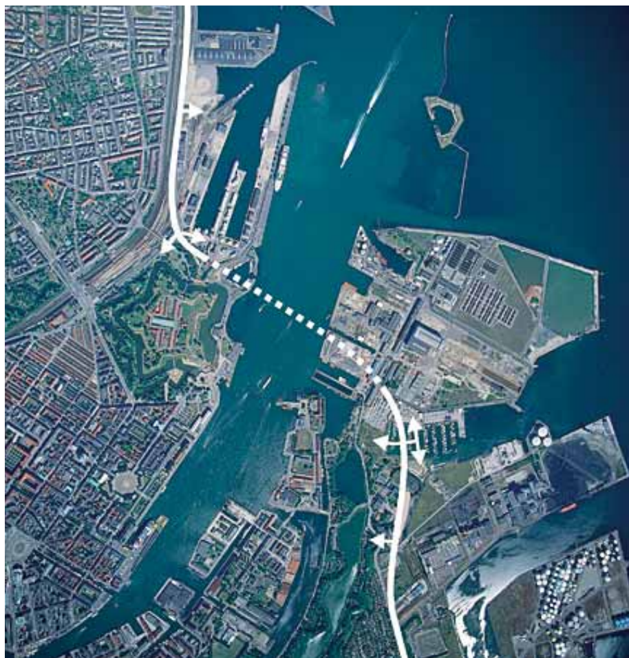
Linjeføring for kort sænkettunnel med tilslutningsanlæg
