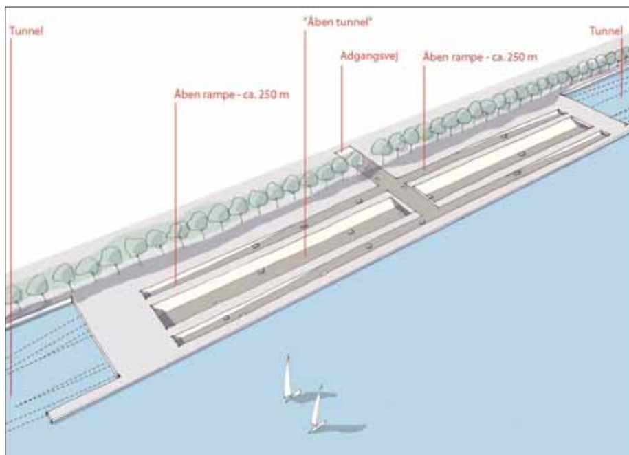
Principskitse af tilslutning udformet som ruderanlæg
