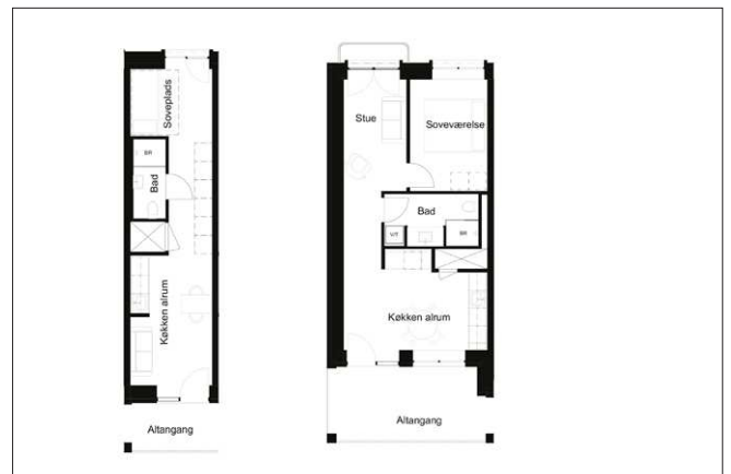
Eksempler på ungdomsboliger og små familieboliger med adgang fra altgang og med dagslys fra to sider
