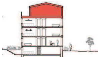
Snit ved Ruten. Eksisterende ejendom med ny tagetage. Illustration: Vandkunsten
