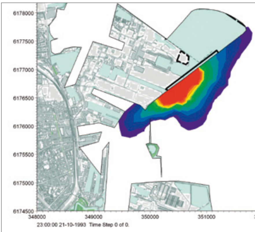
Figur 38 Aflejring af sedimentspild (i cm) som følge af ud- dybning af området langs krydstogtsterminalen.
